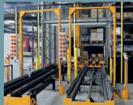
Avant la réception sur le transstockeur, les colis sont mesurés à l'aide d'un lecteur électronique puis saisis en stock
