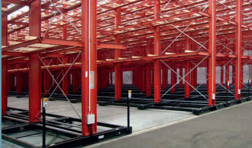
Rayonnage mobile sans marchandises. Commande électrique de chaque chariot mobile individuel par simple pression sur un bouton
