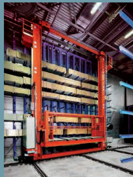
Transstockeur sur rails à deux mâts pour la préparation de commandes dans une entreprise commercialisant du bois
