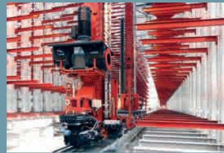
Transstockeur lors d'un trajet test dans un entrepôt vide sans marchandises
