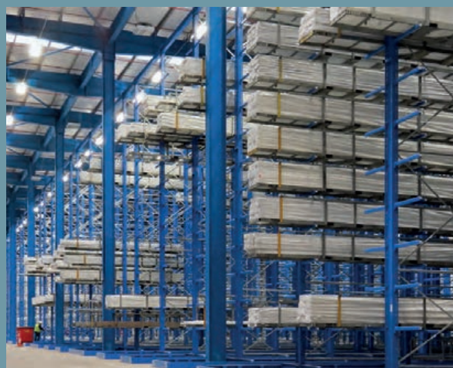
Rayonnage à palettes cantilever de 13,50 m de haut avec 13 niveaux de stockage pour profilés aluminium et PVC, stockés dans des caissons.
