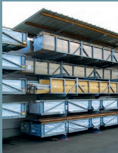
Stockage à l'abri des intempéries de profilés plastiques en conteneur.
