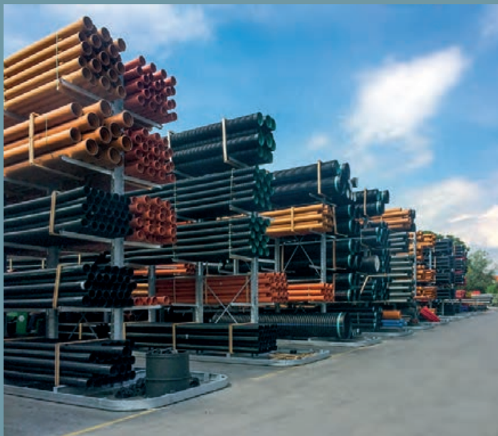
Stockage en extérieur de tubes PVC chez un grossiste. Rayonnages cantilever en version galvanisée à chaud avec rails de guidage pour chariots élévateurs multidirectionnel.
