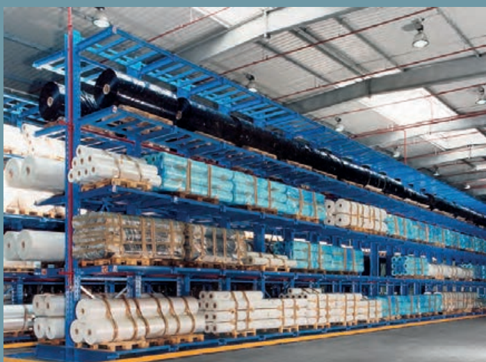
Profilés PVC stockés dans des berceaux à l'abri des intempéries.
